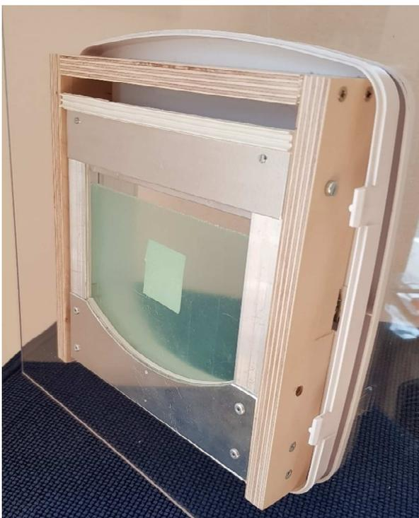
10. Das Alublech an der Oberseite der Aussenseite soll an der vorher montierten „Dichtung“ abdichten.
