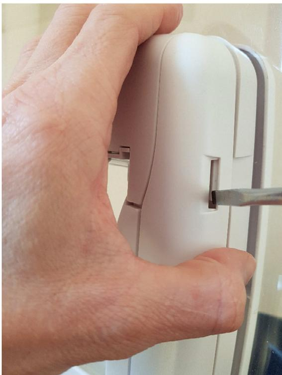
4. Den Frontteil der bestehenden Staywell- Klappe entfernen
